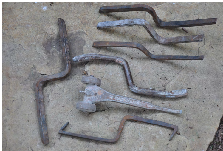
Fer pour joints creux, bicycle pour joints creux, fer rond, fers à lisser de différentes largeurs et fer en losange pour joint en V (rarement vu).
