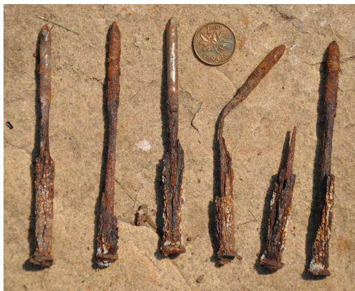
Corrosion marquée de certains connecteurs après 60 ans, clous de 100 mm de longueur.
