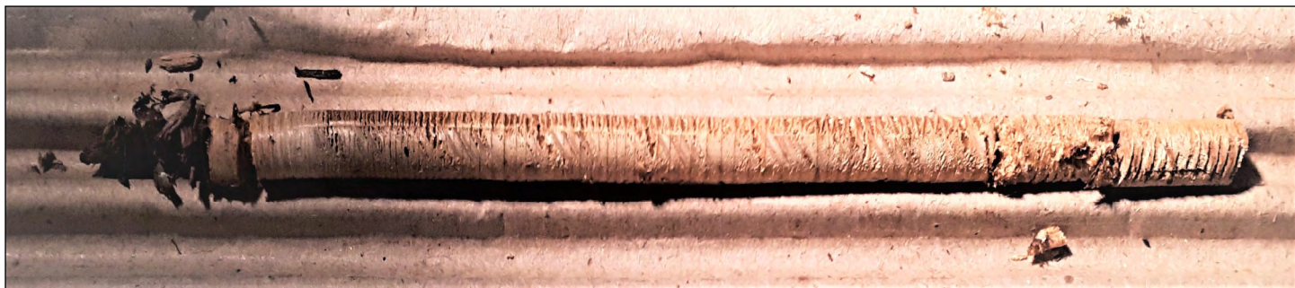
Échantillon d'une poutre de cèdre. Chaque cerne de croissance mesure moins d'un millimètre.
