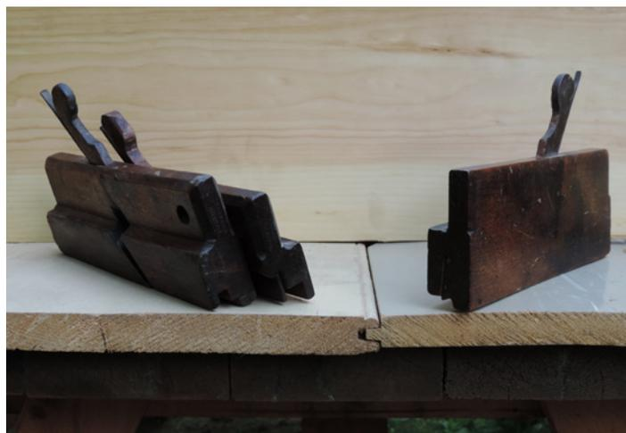
Détail de l'assemblage et les trois rabots utilisés (à gauche une paire de bouvets, dont un servait à faire la rainure et l'autre la languette et à droite le rabot à baguette).
