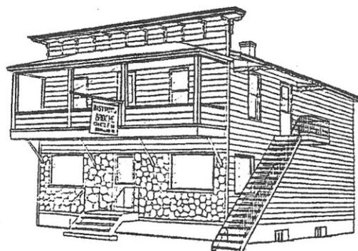
Fig. 1 État existant: le placage de pierre, les fenêtres panoramiques et les modifications apportées au balcon ont altéré la façade de ce bâtiment.
